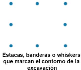
Delinee el área de excavación propuesta utilizando estacas, banderas o whiskers en lugar de pintura en aerosol para marcar radios o arcos; las cuatro esquinas del proyecto; o al delinear el proyecto de excavación. Limite el espacio entre intervalos a aproximadamente 1.2 a 15.2 metros de distancia. Reduzca la
